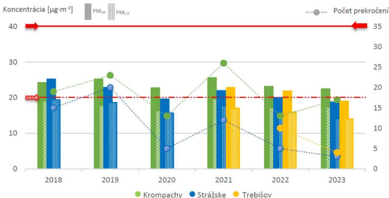
Obr. 9 Priemerné ročné koncentrácie PM_{10} , PM_{2,5} a počet prekročení dennej limitnej hodnoty PM_{10}
